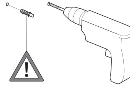
Fig.2E **NOTA BENE:** Scegliere i tasselli ad espansione idonei per la superficie destinata al montaggio.
